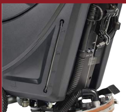
Indicateur de niveau d'eau avec volume visible sur le réservoir
